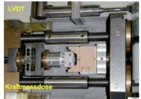
In-situ ESEM Mikroprüfmaschine mit Keilspaltprobe. ESEM In-situ Bruchmechanik: Eine Mikroverformungsmaschine, die in der Probenkammer eines Umwelt-Rasterelektronenmikroskops („ESEM“) eingebaut ist, erlaubt Messungen von bruchmechanischen Daten synchron mit der Oberflächenuntersuchung in der feuchten Atmosphäre des Mikroskops. Dadurch können viele Mechanismen geklärt werden.
