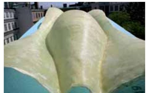
Prototypenmodell eines bionisch inspirierten Fassadensystems, Entwurfsprojekt an der Abteilung für Hochbau 2 im Sommersemester 2007 in Zusammenarbeit mit einer Surfboardfirma und einem Hersteller von Biocomposites.
