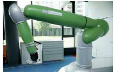
Pneumatischer Leichtbauroboter ROMO
