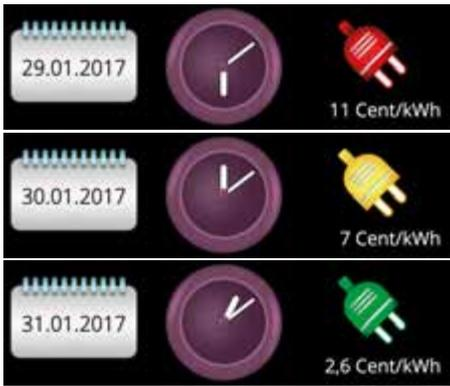
Am Display der Wärmepumpe ist bei Aktivierung der „Smart Price Adaption“ der jeweils aktuelle Strompreis ersichtlich.
