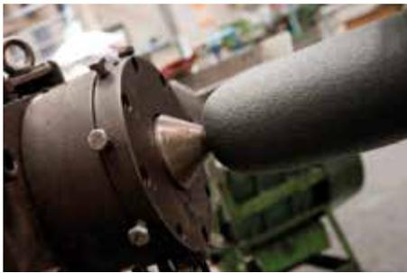
Beim physikalischen Schäumen wird ein Gas als Flüssigkeit in der Kunststoffschmelze unter hohem Druck gelöst. Sobald das Material dem Luftdruck außerhalb des Extruders ausgesetzt wird, führt der Übergang vom flüssigen zum gasförmigen Aggregatzustand zu einer Volumenausdehnung.
