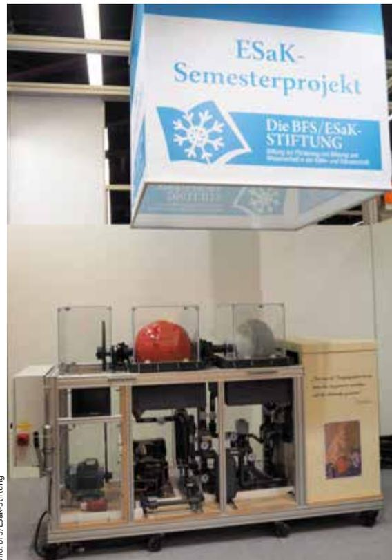
Mit Geldern der BFS/ESaK Stiftung erweckte eine Studentengruppe die 100 Jahre alte ‚Audiffren-Singrün-Kältemaschine‘ wieder zum Leben. Der hermetisch dichte Kühlautomat zeigt, wie lange bereits mit Low-GWP Kältemittel gearbeitet wird und war das Glanzstück der Chillventa 2014 (die veranstaltende NürnbergMesse zählt zu den Gründungsmitgliedern der Stiftung). Heute wird der Kühlautomat für den Lehrbetrieb der ESaK und der Bundesfachschule Kälte-Klima-Technik genutzt.
